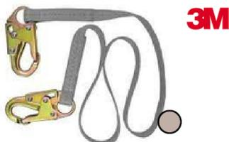
Eslinga sencilla para posicionamiento, con dos ganchos de  $\frac{3}{4}$ " de apertura. Longitud de 1.8m. Subsistema parte de un sistema personal de detención de caídas, posee tres puntos de anclaje. Este elemento permite al usuario desplazarse manteniéndose siempre anclado por lo menos de un punto, alternando uno a uno los ganchos de los extremos de la eslinga.
